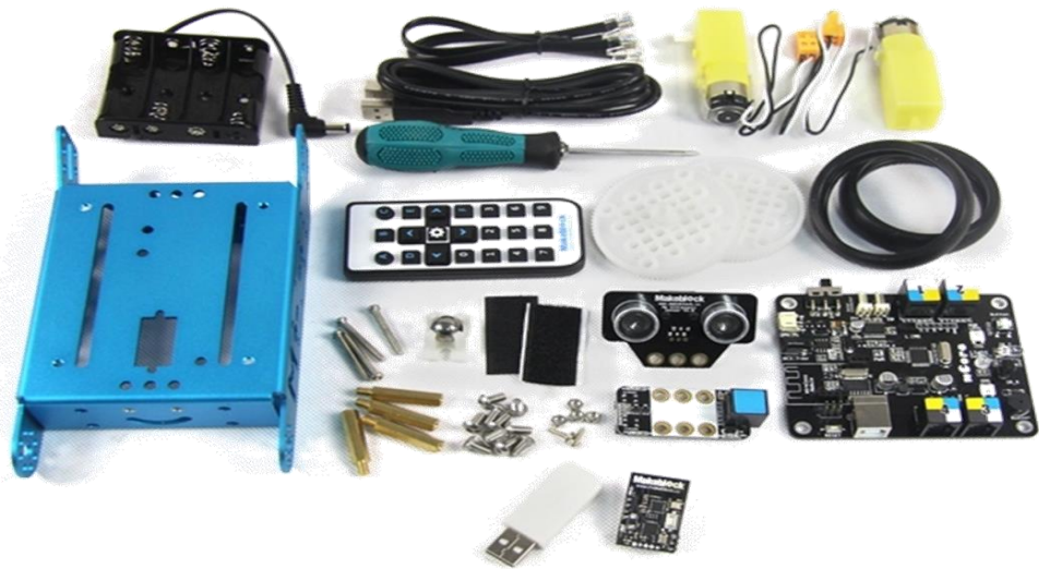
Hình 3. Các linh kiện cần thiết để lắp ráp mBot
