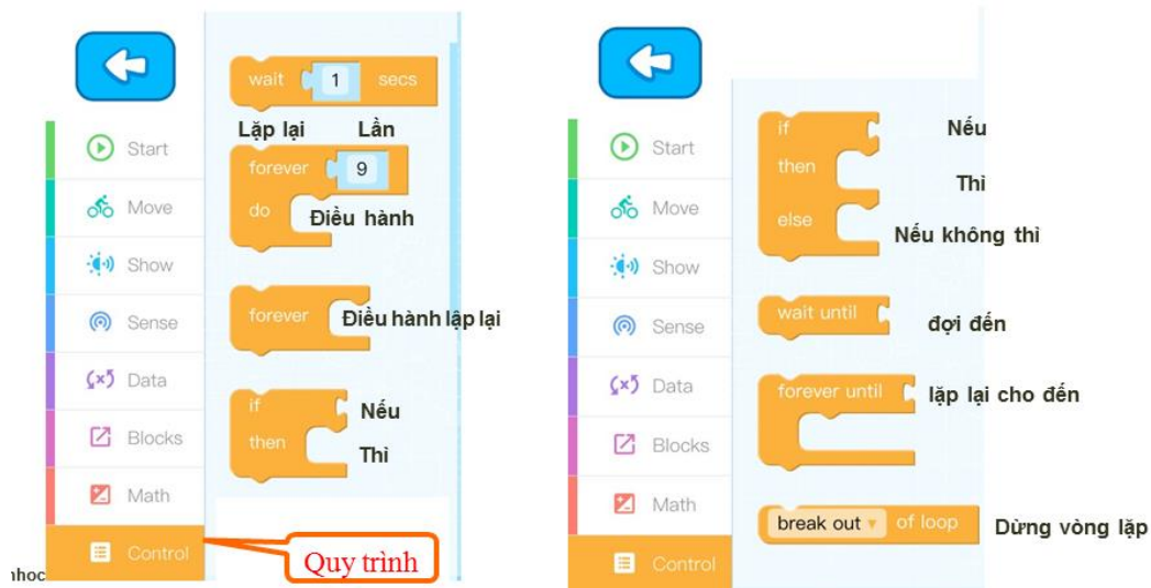
Hình 14. Các cấu trúc lệnh điều khiển chương trình chạy mBot có thể ứng dụng trong phần điều khiển [Control] của mBlock
