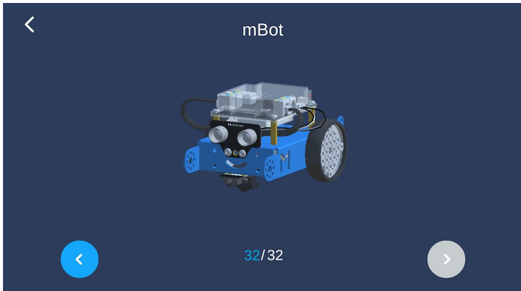
Hình 1. Tính năng mô phỏng các bước lắp ráp các bộ phận robot trong không gian 3 chiều
