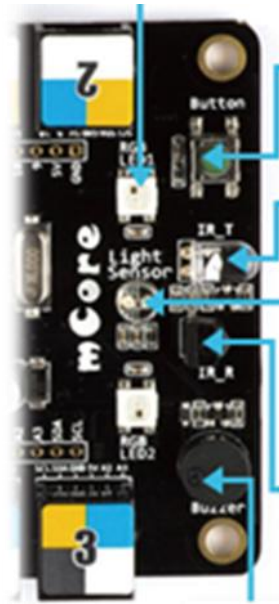
Hình 7. Bộ phận cảm biến ánh sáng trên bảng điều khiển.
